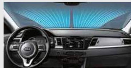
**Sistema de desembaciamento automático** Quando detetam a formação de condensação na parte interior do para-brisas, os sensores deste sistema ligam automaticamente o desembaciador, para assegurar a máxima visibilidade e segurança.
