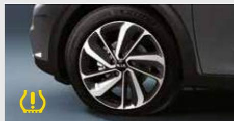
**Sistema de Monitorização da Pressão dos Pneus (TPMS)** Verifica de forma constante a pressão interior de cada pneu individualmente. O sistema mostra-lhe os valores que se encontram abaixo do normal, exibindo essa informação no ecrã do painel de instrumentos.
