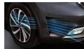
**Cortina de ar** A cortina de ar favorece a aceleração do fluxo de ar na parte dianteira, diminuindo a resistência ao ar provocada pela turbulência e aumentando o aerodinamismo.
