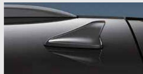
**Antena shark** Elegante e aerodinâmica, a antena shark oferece a receção ideal para rádio AM/FM, DAB (Digital Audio Broadcast) e sistemas de navegação.
