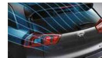
**Spoiler traseiro** Colocado acima da porta da bagageira, o spoiler traseiro aproveita a passagem do ar para ajudar a estabilizar a carroçaria na condução a alta velocidade.
